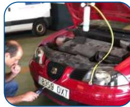
Fuga en condensador.
