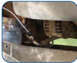
Fuga en toma de baja presión.
