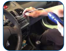
Fuga en evaporador.
